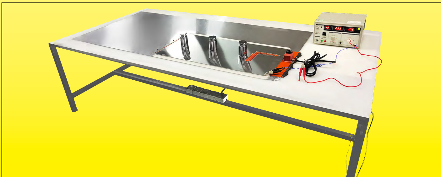
เครื่องมือวัดสำหรับการรั่วไหลของกระแสรวมที่สภาวะเย็น
